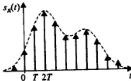
Рисунок 3.5 – Представление дискретного сигнала в виде последовательности взвешенных дельта-функций
