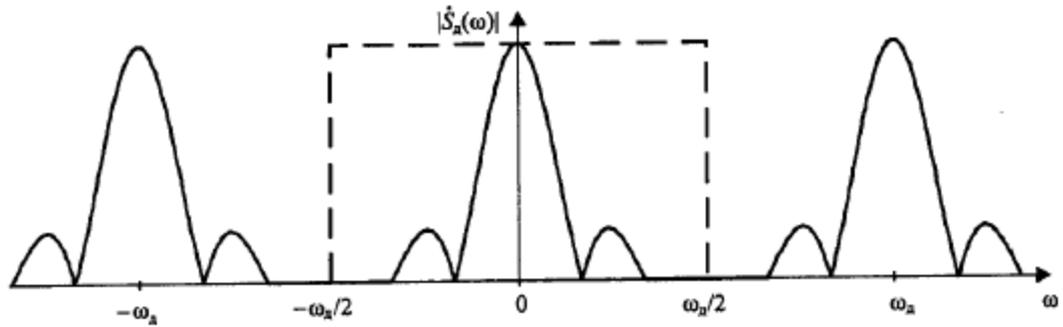
Рисунок 3.6 – Спектр дискретного сигнала
